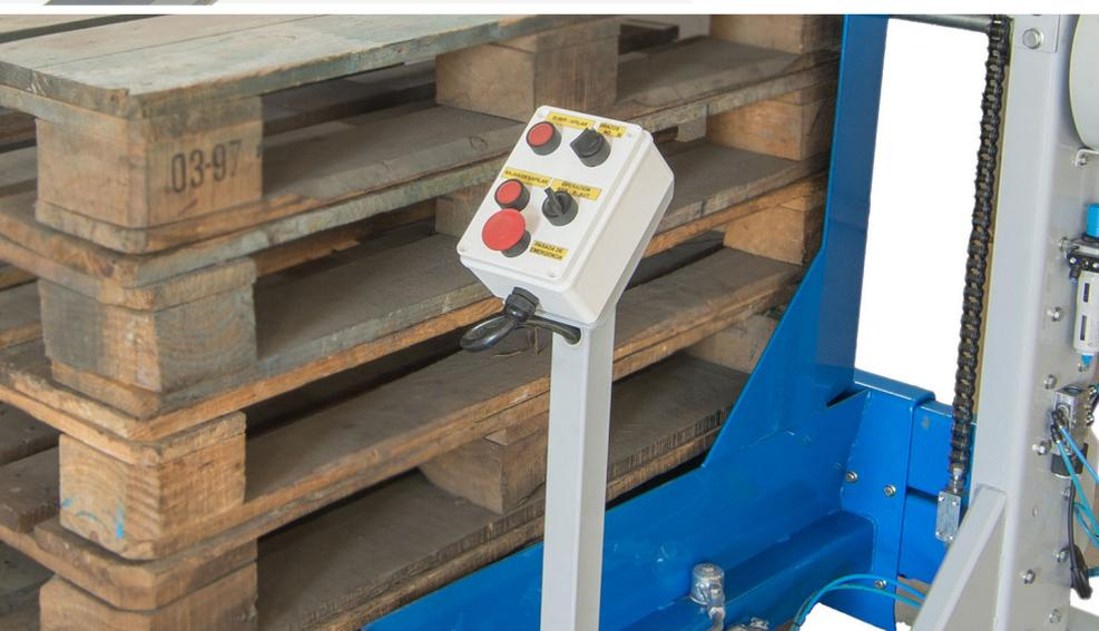
Es un equipo utilizado para almacenar y dispensar pallets vacíos, facilitando el orden y eliminando el riesgo de accidentes por la manipulación de los mismos.
