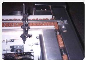
Este sistema de carga automática servocontrolado ,puede ser colocado para alimentar cualquier envasadora Flow-Pack de alto rendimiento. El Cargador a 90 admite todo tipo de productos pudiendose realizar un rápido y sencillo cambio de formato.
