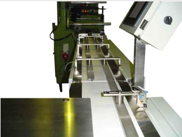
Este sistema de carga automática puede ser colocado para alimentar cualquier envasadora Flow-Pack. El Cargador automático 180 admite todo tipo de productos pudiéndose realizar un rápido y sencillo cambio de formato.
