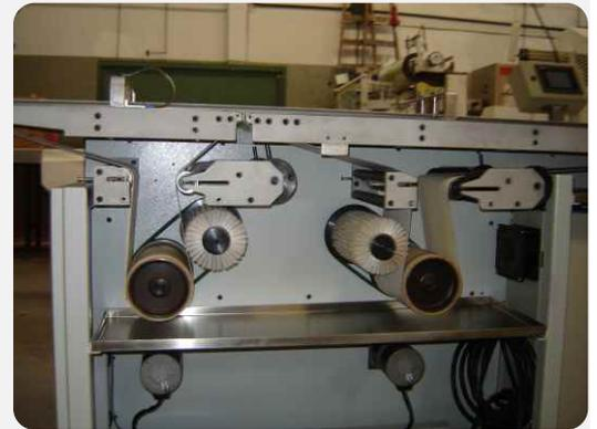
El sistema de carga a 180 grados permite una gran velocidad de carga con un máximo cuidado del producto, la velocidad de carga puede llegar a los 300 productos minuto dependiendo del número de cintas que componen el sistema.
