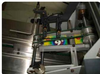
El comando del movimiento de descarga está accionado por un servomotor, esto garantiza una alta velocidad ( hasta 500 productos minuto) y una excelente ubicación al descargar en lugares específicos
