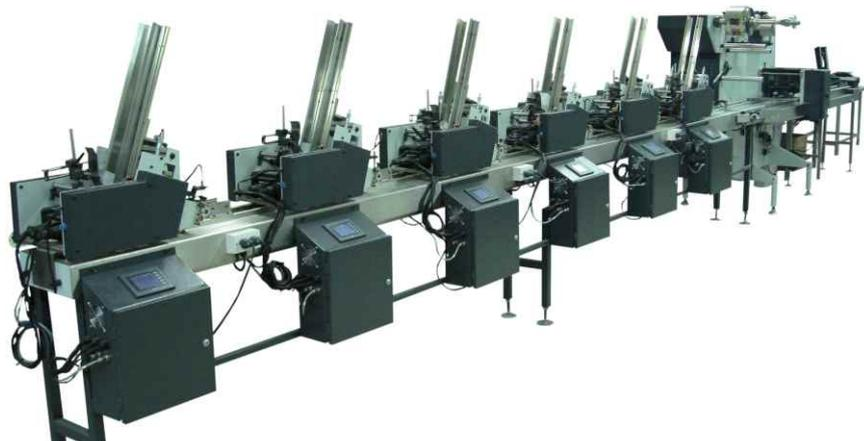
El cargador de figuritas o cartas fue diseñado para abastecer de forma múltiple a un sistema de empaque automático no importando la sincronización ni la periodicidad de trabajo
