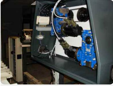
Mandos con servomotores, transmisiones con tornillos a bolas recirculantes y accionamientos a través de un manifold neumático. Esto garantiza una gran precisión en los movimientos y una alta confiabilidad con muy bajo mantenimiento.
