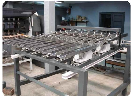
Al cargador se le pueden adaptar fácilmente sistema de transporte por vibración y también se puede girar el producto en el caso que sea rectangular
