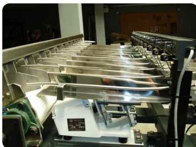
Puente de medición de presión. Este puente sensa el estado de la presión de la línea en cada canal, dando la orden al cargador de anular el canal que tenga poca presión
