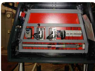
Electrónica de última generación compuesta por PLC, Drivers Inteligentes, y sistemas de protección de los circuitos eléctricos.
