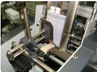
El cargador cuenta con guías laterales para contener el producto, con una pala articulada para acomodar el conjunto de las mismas y con dos tornillos micrométricos para asegurar que solo descargue de a 1 por vez
