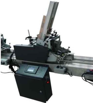
El cargador de tarjetas telefónicas fue diseñado para abastecer a un sistema de empaque o de impresión de tarjetas telefónicas.
