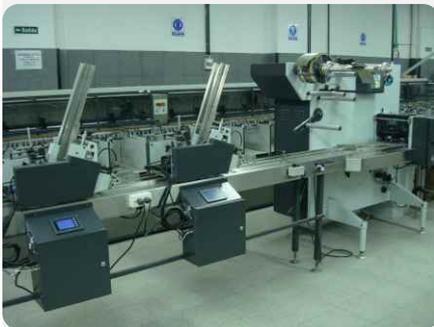
En un sistema de envasado se pueden colocar múltiples feeders. La comunicación entre los mismos permite alternar y superponer las entregas de tarjetas
