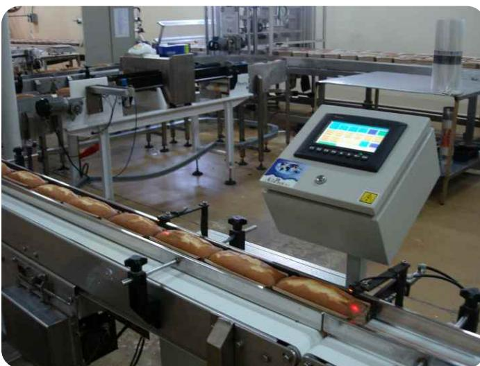
El control de todo el sistema está realizado por un PLC y por intermedio de un Panel Touch se accede a los parámetros del mismo facilitando de esta manera los cambios de formatos para los diferentes productos.
