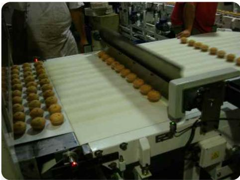
Una de las primeras cosas a realizar es el alineado del producto, para ello el sistema cuenta con un alineador de dos palas comandado por un motor paso a paso, esto garantiza una alta velocidad y un ajuste automático a las diferentes velocidades del proceso.
