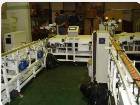
En este caso el sistema de carga múltiple esta compuesto por dos cargadores que a su vez alimentan a dos máquinas flow pack. La velocidad de producción de estos sistemas puede llegar a los 350 paquetes minuto dependiendo del producto.
