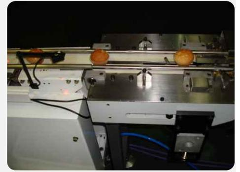
Una vez que el sistema de traspaso traslado el producto desde la cinta de dosificación hasta las cintas de carga ellas se encargan de sincronizar y entregar el producto a la envasadora, el último tramo de estas cintas esta acoplado a la máquina y es la que realiza el traspaso entre las cintas de carga y la Flow Pack
