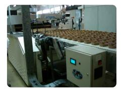
El control de los sistemas de traspaso para productos difíciles está realizado por un PLC y por intermedio de un Panel Touch se accede a los parámetros del mismo facilitando de esta manera los cambios de formatos para los diferentes productos.
