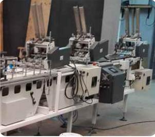
El sistema de ensobrado inicia su proceso con la dosificación del card wallet, luego adosa la tarjeta con chip con una precisión milimétrica y por último, si es necesario le aplica un inserto u otro tipo de tarjeta.
