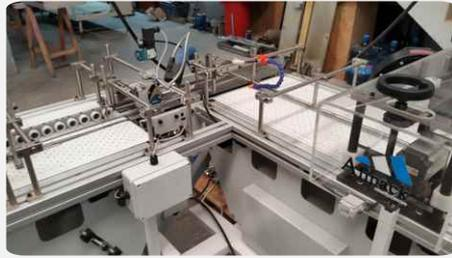
El cerrado del sobre se realiza en forma automática y controlada, para ello se utiliza un sistema de dosificación de adhesivo caliente. Una vez terminado el proceso de plegado y cerrado la máquina entrega los sobres en perfecto orden y si Ud. lo desea también puede fraccionarlos en diferentes lotes.
