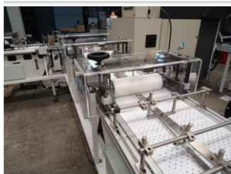
El sistema de traslación del producto está compuesto por varias cintas integradas a un sistema de vacío, esta conjunción de elementos permite que el producto pueda ser manipulado sin que el mismo se desacomode.
