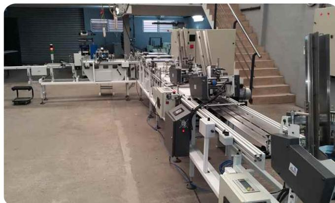
Esta máquina está especialmente diseñada para realizar el ensobrado de tarjetas telefónicas con chip o tarjetas rígidas. Dicha máquina está completamente comandada por servomotores, esto permite un control exacto del proceso garantizando así una alta velocidad y un óptimo acabado final del producto.
