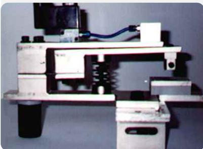
Una de las partes a colocar sobre la envasadora es el sistema de troquel, el accionamiento de dicho sistema es neumático, lo que garantiza una alta confiabilidad y un mínimo mantenimiento.
