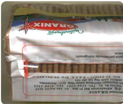
Vista de un paquete terminado en donde se puede apreciar la cintilla de desgarre colocada y la lengüeta de apertura Fácil.
