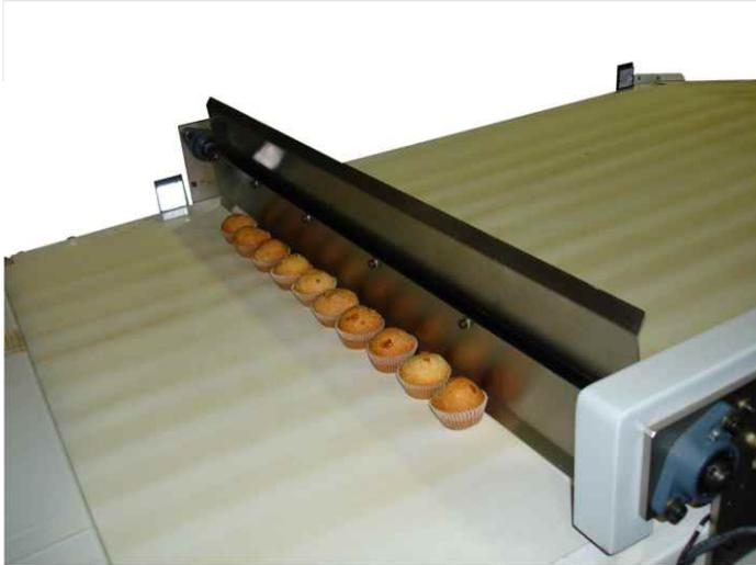
El alineador de productos es un sistema utilizado para obtener la linealidad en una o varias filas de productos que vienen desperejos desde la línea de producción.
