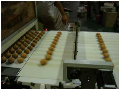
El sistema de alineación está manejado por un motor paso a paso, esto nos permite acomodarnos automáticamente a las distintas velocidades de la producción sin ninguna intervención del operador
