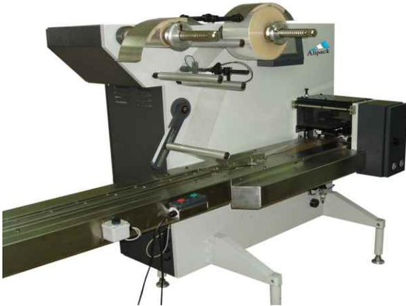
La empaquetadora W1 es una máquina automática continua del tipo de carga horizontal.
