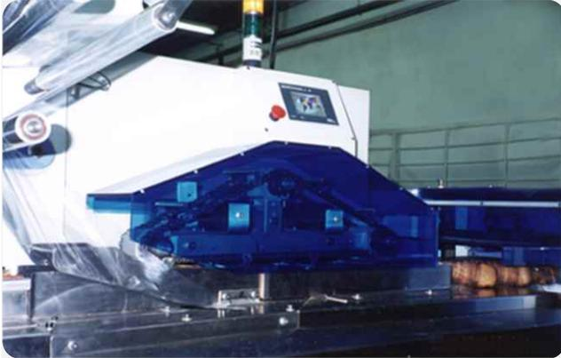
La empaquetadora W1AS es una máquina automática continua del tipo de carga horizontal.
