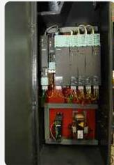
El tablero eléctrico de la máquina es de última generación y posee un sistema de control multiteje para comandar los 7 servomotores que tiene la máquina. Por otro lado tiene un PLC para comandar temperaturas, alarmas y comandos básicos del sistema. De esta forma se logra dar al sistema una gran confiabilidad y precisión
