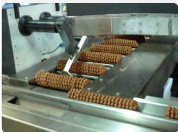
Otro de los dispositivos de esta empaquetadora es el sistema de traspaso. Este esta comandado por dos servomotores que interpolan la curva de entrada de producto, garantizando así un excelente resultado en el cuidado del producto.
