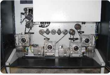
Los movimientos de la W2 están comandados exclusivamente por servomotores reduciendo así la cantidad de piezas mecánicas en el sistema. Al tener los movimientos comandados por servos la empacadora ofrece una gran versatilidad en sus movimientos logrando así un paquete mas ajustado y prolijo
