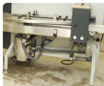
La máquina trae un sistema de aspiración de aire, dicho sistema asegura la estabilidad del paquete durante el paso por el acompañador lateral y ciñe el producto al envoltorio logrando así una mejor terminación del mismo
