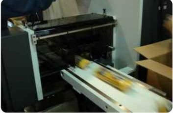
**NO PAQUETE NO PRODUCTO:** La máquina contiene un sistema que no realiza el paquete si no viene producto por la cadena de alimentación reduciendo notablemente el scrap por paquete vacío.
